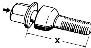
Die Befestigung der 17 mm Distanzringe an den Radnaben erfolgt mit den Serien-Radschrauben, Teile-Nr. 996.361.203.00 (Maß X = ca. 45 mm). Anziehdrehmoment: 130 Nm. Die Radbefestigung am 17 mm Distanzring erfolgt mit Radmuttern, Teile-Nr. 999.182.003.36. Anziehdrehmoment: 130 Nm.
